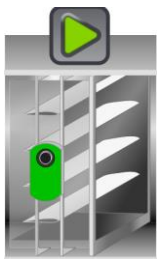
Ventelles fixes ouvertes quand fin de course détecté
